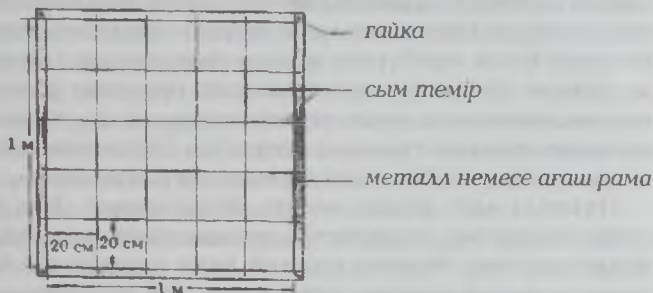
47 сурет. Сым темірмен кішкене төртбұрыштарға ( 400 \text{ см}^2 ) бөлінген төртбұрыш рама
